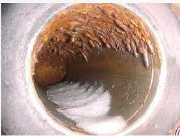
**El problema:** La presencia de humedad y oxígeno en el interior de las cañerías de los sistemas de lubricación y sello, generan óxidos que con el transcurso del tiempo se transforma en herrumbre, siendo estas las principales causas de fallas en turbomaquinarias.
